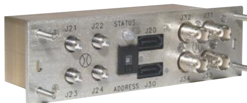
RSM - Redundant Switch Module
